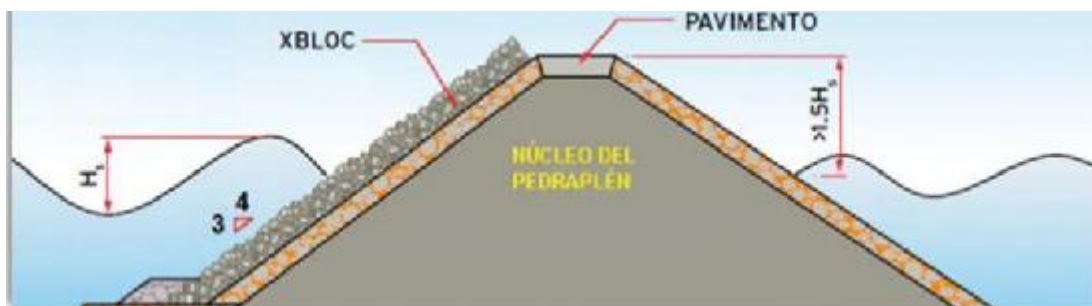
Figura 3. Escolleras conformadas por Xbloc®
