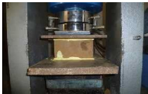
Figuras 5 y 6. Detalle de ensayos a compresión axial y flexión en BTC.
