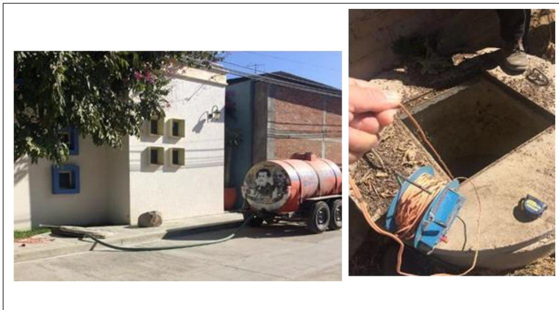
Figura 3. Pruebas geohidrológicas tipo Slug para definir la capacidad de infiltración del pozo.
