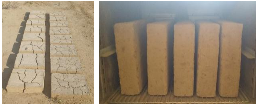
Figura 3. Izq.: Adobes sin estiércol de burro. Der.: Adobes de suelo + estiércol de burro + 15 % resina de pino.
