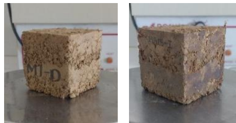
Figura 2. Muestras de suelo + estiércol de burro (izquierda) y de suelo + estiércol de burro + 15% resina de pino (derecha).
