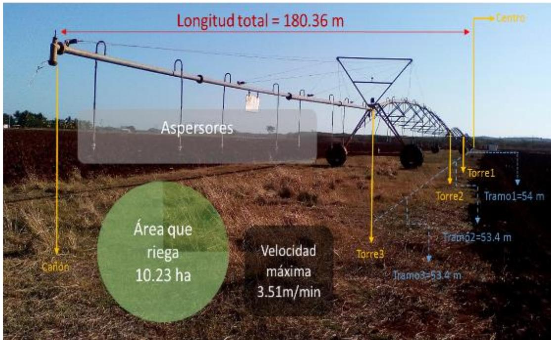
Figura 5. Características de la máquina de pivote central.
