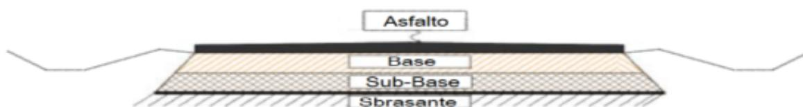
Figura 1. Sección de un pavimento flexible.
