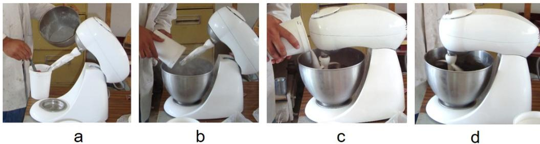
Figura 2. Elaboración de mezclas de mortero: a) Colocación del CP en el tazón, b) adición de PV, c) adición de la arena sílica, d) mezclado
