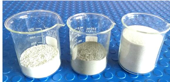
Figura 1. Materiales empleados para la elaboración de los morteros. De izquierda a derecha a) Polvo de vidrio, b) Cemento y c) Arena sílica
