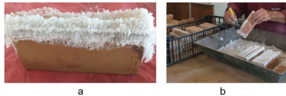
Figura 5. Preparación de ladrillos para pruebas: a) Ladrillo con sulfato de sodio cristalizado y b) Limpieza de ladrillos.
