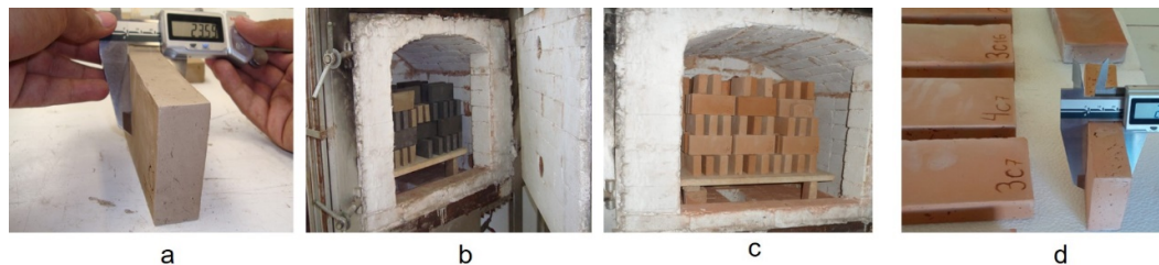
Figura 3. Proceso de cocción de ladrillos: a) Medición de ladrillos previo a su cocción, b) Colocación de ladrillos en el horno, c) Ladrillos cocidos y d) Medición de ladrillos después de su cocción.
