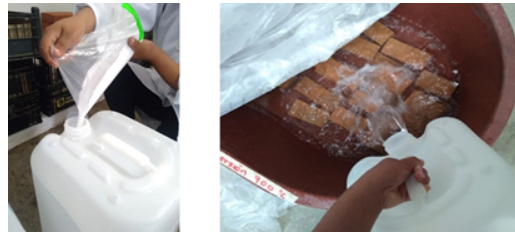
Figura 4. Exposición de ladrillos al ambiente agresivo simulado: a) Preparación de solución y b) Adición de la solución al contenedor.
