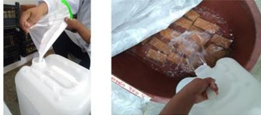
Figura 4. Exposición de ladrillos al ambiente agresivo simulado.
