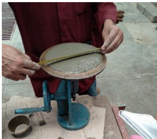
Figura 1. Detalle del uso de la mesa de fluidez para obtener una consistencia de mezcla adecuada para la adición de fibras.
