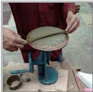
Figura 1. Detalle del uso de la mesa de fluidez para obtener una consistencia de mezcla adecuada para la adición de fibras.
