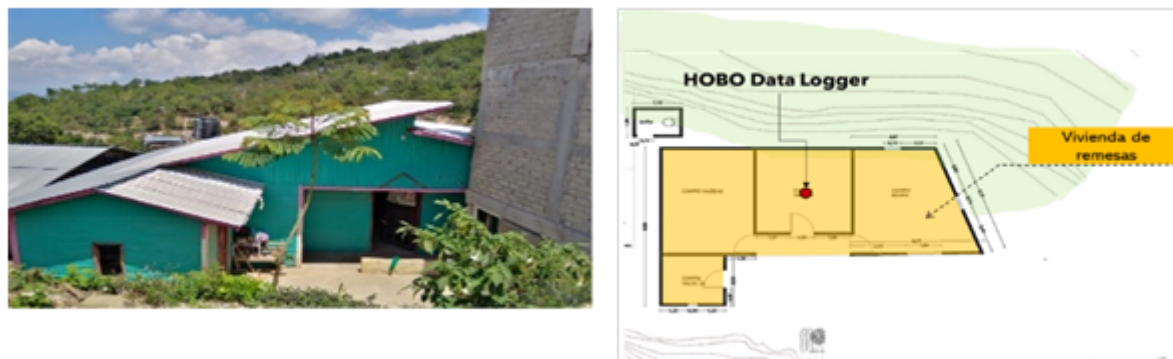
Figura 3. Diagnóstico climático de VR mediante instrumentación con HOBOS dataloggers. Fuente: Fotografía y elaboración de autora
