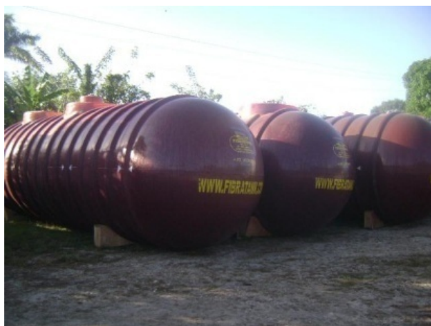
Figura 4. Soportes de los tanques para su almacenamiento.
