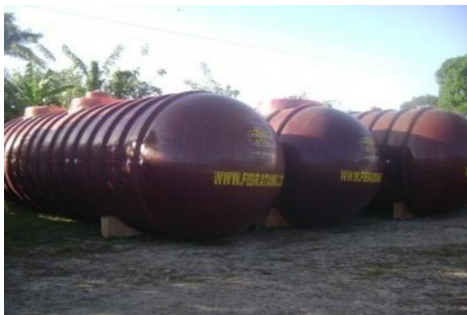
Figura 3. Soportes de los tanques para su almacenamiento.
