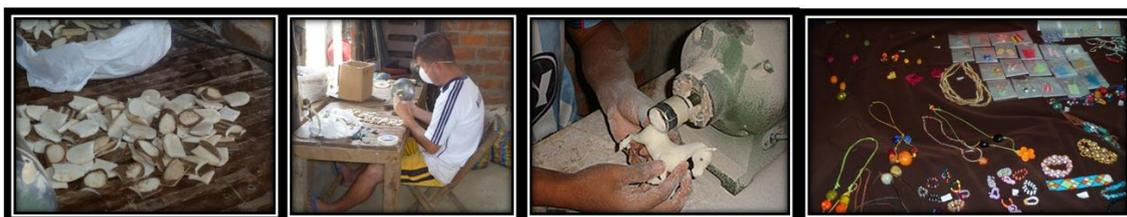
*Figura 2: de izquierda a derecha: corte, torneado, escogida de anímela y empaque de la tagua (fuente: elaboración propia).*
